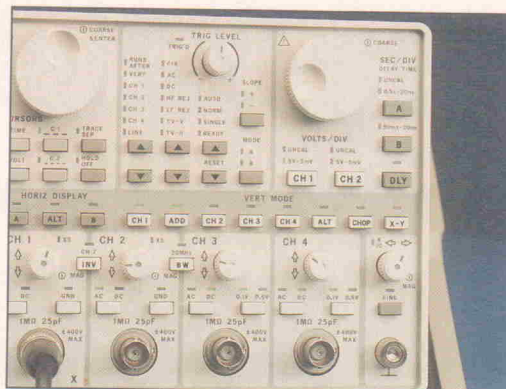
Bedienung über Tasten und Encoder – hier am Beispiel des Iwatsu SS-7611 – erleichtern dem Prozessor die Arbeit beispielsweise beim Setup.
